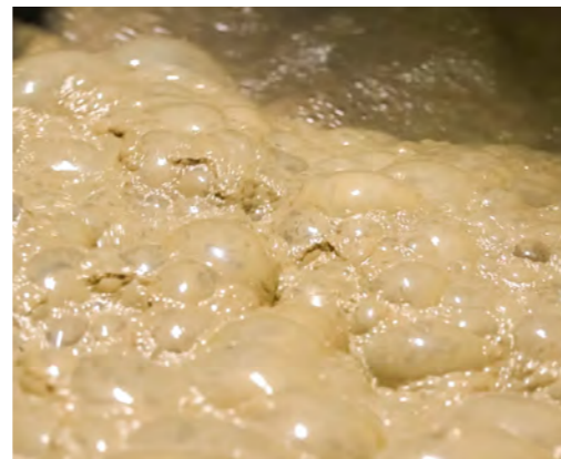
Ore mining and bubble formation in a flotation reactor. Erzgewinnung und Blasenbildung im Flotationsreaktor.
