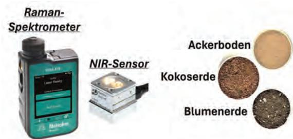
Abbildung 1. Raman-Spektrometer und einer von fünf genutzten NIR-Sensoren sowie Beispiele der untersuchten Bodenproben.
