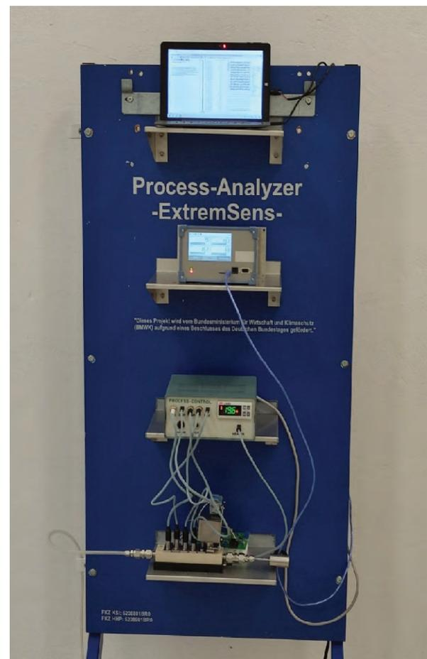
Abbildung 1. Anwendungsbeispiel eines modularen Multiparameter-Messsystems als Prozess-Analysator für die Lebensmittelindustrie.
