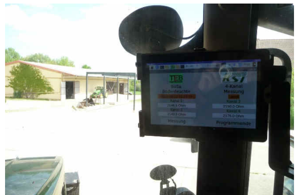
Abbildung 3. Tablet zur Steuerung des Messprogramms und zum Monitoring der Daten in der Traktorkabine.
