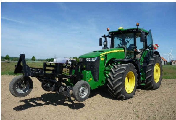
Abbildung 1. Ackerdreirad im Frontanbau des Traktors bei einer Versuchsfahrt (angehobener Zustand, Transportstellung).
