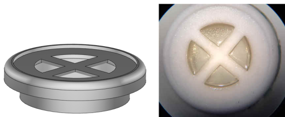
Abbildung 2. Technische Zeichnung der Keramikstruktur und Mikroskopaufnahme einer \text{Li}^+ -sensitiven Membran, stabilisiert in Keramikstruktur.
