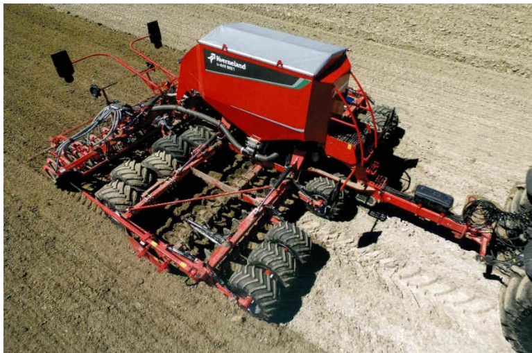
Abbildung 4. Kommerzielle Drillmaschine U-Drill 6001 von Kverneland mit aktiver Einstellung der Saatgutablagetiefe.
