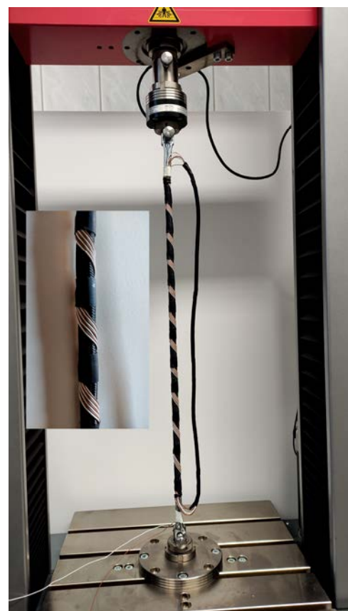
Abbildung 1. Sensorsimulation seilbasierter Sensoren für induktive Auswertung.
