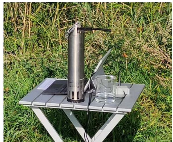
Abbildung 2. Multiparametersonde für limnologische Anwendungen (KSI Meinsberg).
