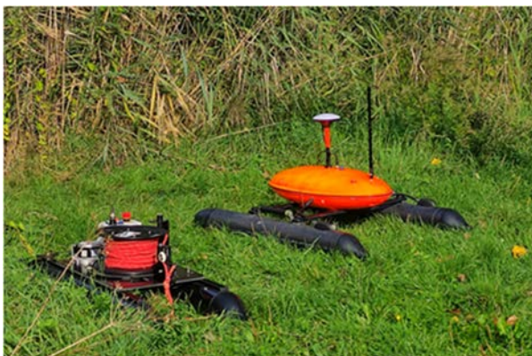
Abbildung 1. Messplattform Sonobot® der Fa Evologics® mit Winde zur Aufnahme der miniaturisierten Multiparametersonde (KSI Meinsberg).
