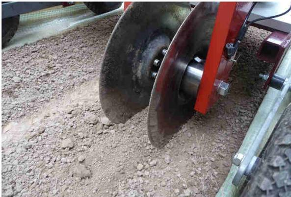
Abbildung 2: Drillscheiben als Elektroden zur Impedanzmessung in Ackerböden.
