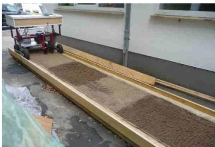
Abbildung 3. Versuchsbeet zur Erprobung der Sensorik bei Variation verschiedener Messparameter.
