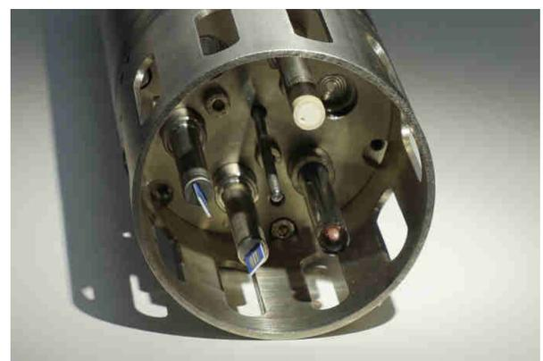
Abbildung 1. Sensorkonfiguration der miniaturisierten Multiparametersonde.
