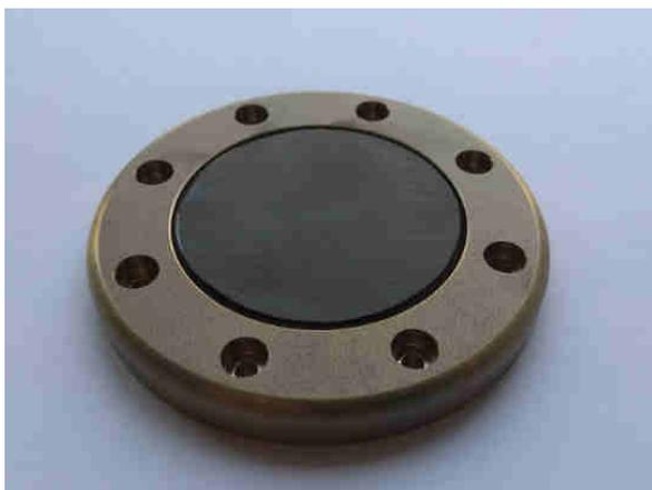
Abbildung 2. Konfektioniertes Sputtertarget aus pH-sensitiven Glas.
