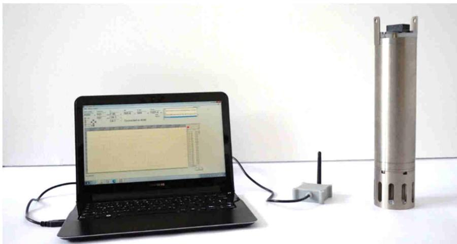
Abbildung 2. Steuerrechner mit Auswerteprogramm, Funkmodul ZIGBEE ISM 3.0 2.4 GHz und Multiparametersonde mit integriertem Datenlogger.
