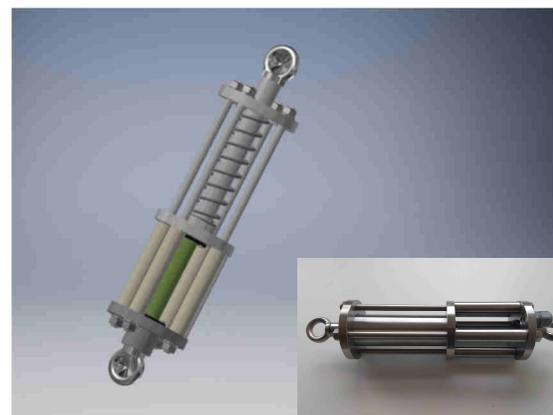
Abbildung 2. Konstruktion und Ausführungsform eines federbasierten Sensors (Gehäuse entfernt).
