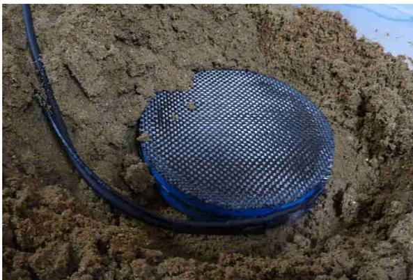
Abbildung 3: Impedanzsensor zur Bestimmung des Sickerlinienverlaufs in erdgebundenen Deichbauwerken.
